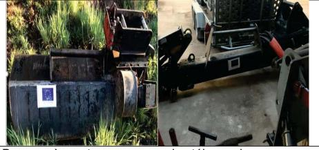
Broyeur à marteaux sur perche télescopique marque SEVE
